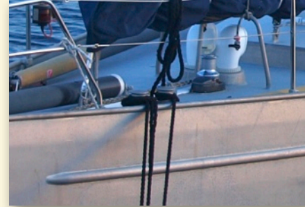
Werden keine Klüsen verbaut, müssen die Poller oder Klampen so montiert sein, dass die Trossen nicht scheuern können!
