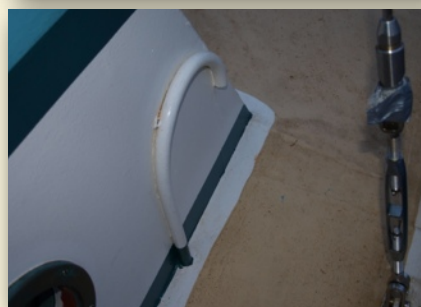
Tankentlüftung und Tankdeckel (lassen sich auch bei Eis öffnen) von LA BELLE EPOQUE.
