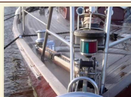
Nicht ausreichend: zu kleine Klampen am Vordeck und offene Lippen - eine Garantie, dass diese schöne Yacht in schweren Wetter im Hafen oder mit Landleinen nicht ausreichend gesichert werden kann und die Trossen aus der Lippe springen! Die Idee, wie die alten Walfänger einen übergroßen, zentralen Poller am Vordeck zu fahren, ist allerdings interessant, so können sich Schoten und Segel nicht verheddern und das Deck ist aufgeräumt.
