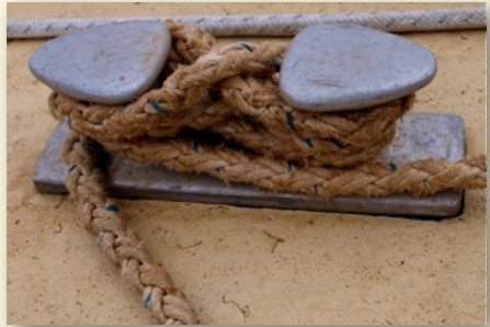
Die Poller von LA BELLE EPOQUE: Beide Pollerarten haben sich bewährt, wobei die Doppelkreuzpoller den Vorteil bieten, dass an ihnen auch zusätzliche Trossen mit einer Schlaufe festgemacht werden können, während die Knopfpoller meist mit einer starken Trosse voll belegt sind.
