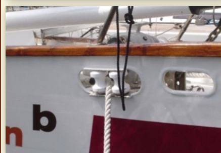
Klüsen und Lippen müssen geschlossen sein, die Trossen vor Schamfilen schützen oder groß genug für Schamfilenschutz sein!
