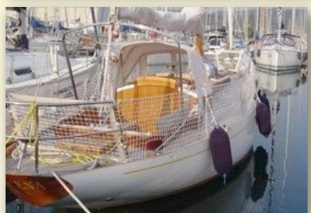
Eine hohe und stabile Reling gibt Sicherheit an Deck. Yachten mit Kinder oder Tiere an Bord fahren gerne ein Relingsnetz. Fährt die Yacht in sehr kalte Seegebiete mit Gefahr von Decks-Vereisung, muss das Netz allerdings vorübergehend abmontiert werden!
