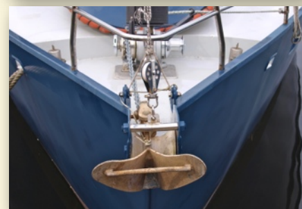
Die Ankerklüse muss so ausgeführt sein, dass die Kette oder Trosse auch bei heftigen Schiffsbewegungen nicht von der Rolle springen kann.
