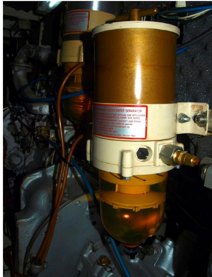
Dieselfilter mit Wasserabscheider können bereits vom Haupttank zum Tagestank angeordnet werden und ermöglichen eine weitere Filteranlage zwischen Tagestank und Motor.
