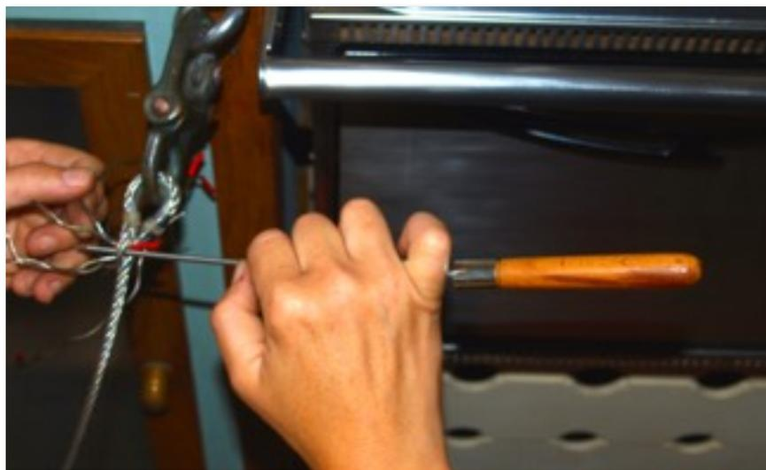
Zwischenbild: zum Öffnen der Zwischenräume kann eine Spleißnadel oder ein kleiner Flachschraubenzieher verwendet werden.
