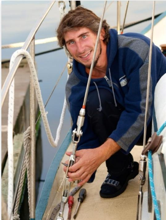
Blauwasseryachten nur Wantenspanner mit offener Hülse in Frage, die aus einer Materialkombination geschmiedet sind, welche ein "Festfressen" der Gewinde verhindert. Unter Festfressen versteht man den Umstand, dass Verschraubungen, die zur Gänze aus dem gleichen Edelstahl gefertigt sind, beim Verschrauben unter Zugbelastung verreiben können.
