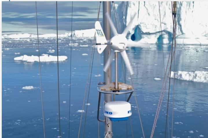
überlegt werden. Durch zu unüberlegte Montage kann auch hier wieder die Stabilität der Yacht negativ beeinflusst werden.
